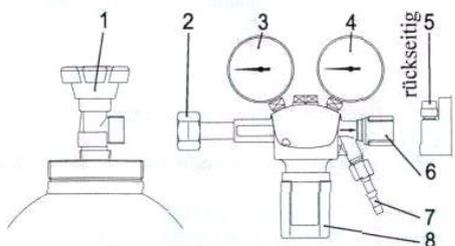
1. Клапан баллона в соответствии с DIN 477
