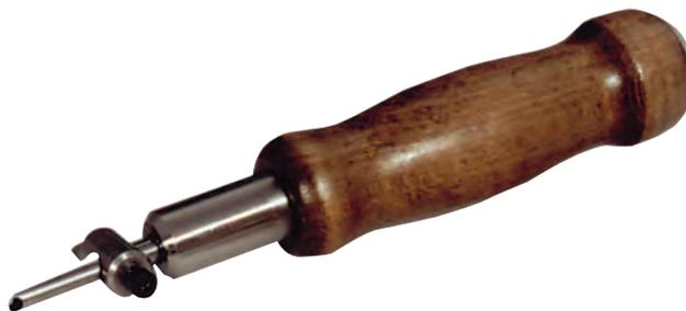
Предназначен для разделки шва в стандартных и жестких напольных покрытиях перед сваркой. Конструкция ножа с выставляемой направляющей позволяет прорезать шов точно по стыку.
