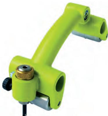
Производительный резак с 2 направляющими роликами, дающий всегда точный рез по стыку, для средних площадей. Конструкция резака позволяет точно регулировать 4-х сторонним лезвием необходимую глубину выборки материала.
