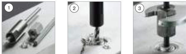
Если резьба тугая, следует распылить спец. средство или нагреть. Шпильки сделаны из высококачественного материала — шпильки не перекашивать и не греть.
