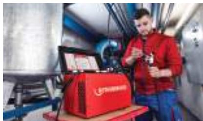
После установки клемм на трубе процесс заморозки осуществляется автоматически
