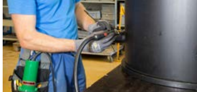
MINOR подключен к LABOR S в качестве внешнего источника подачи воздуха
