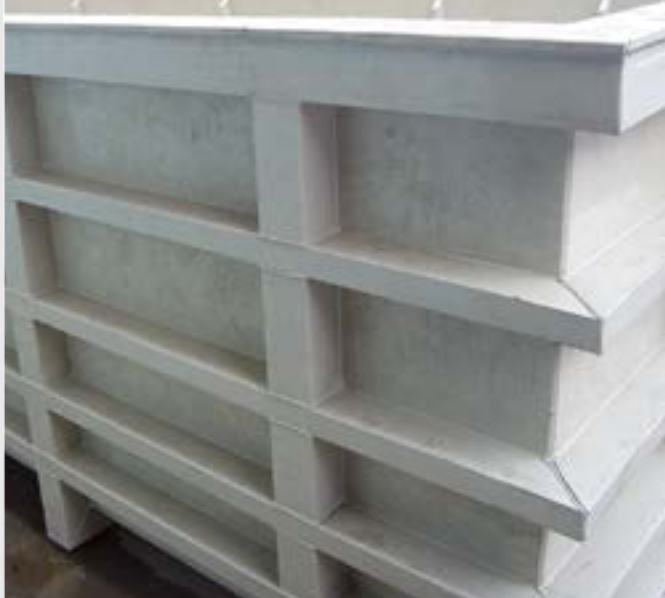
Гальваническая ванна, Турция. Материал ПП
