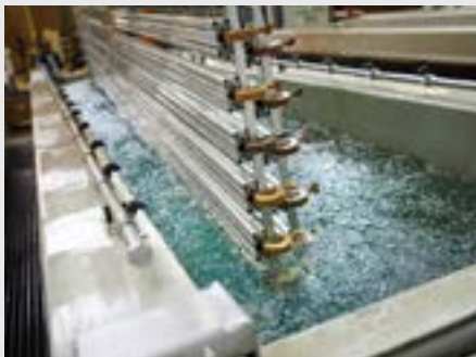
Гальваническая ванна из полипропилена © Collini www.collini.eu
