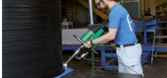
WELDPLAST S6 легко направлять благодаря практичной рукоятке в форме штурвала
