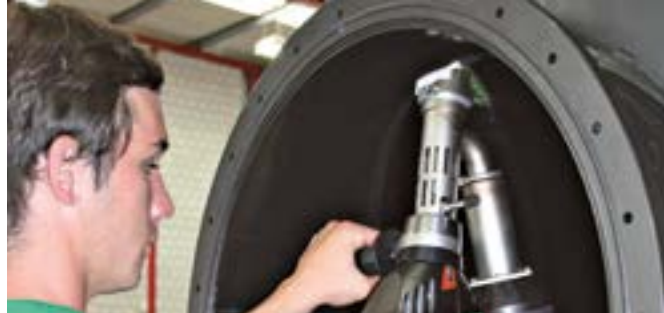
Простая сварка даже по внутреннему радиусу
