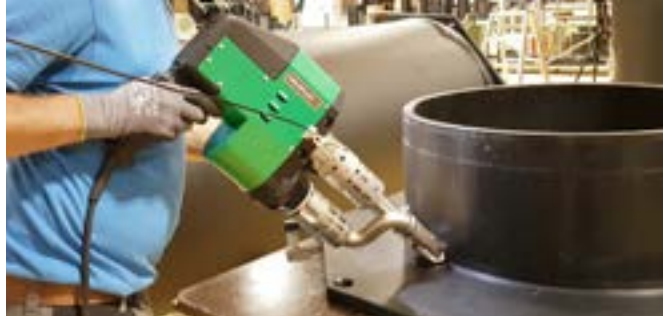
Мощный WELDPLAST S4 в работе
