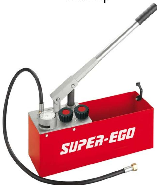
Ручной опрессовочный насос PR 50 для точной и быстрой проверки давления, а также герметичности трубопроводных систем и резервуаров в водопроводных, отопительных и сантехнических системах, в системах сжатого воздуха, паровых, в системах сжатого воздуха, паровых, охладительных и масляных установках, для котельных и при строительстве напорных резервуаров, идеален для заполнения солнечных батарей.
