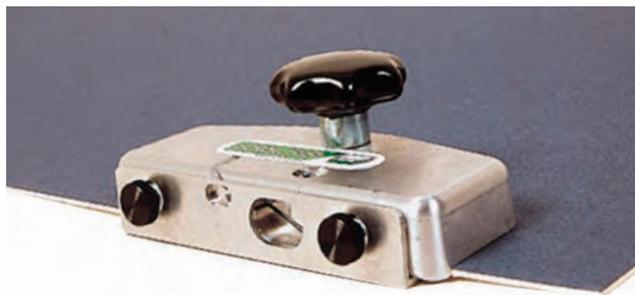
Предназначен для скашивания кромок под углом 25° на поверхности плиток из ПВХ и дизайнерских покрытий после их нарезки. С упором для быстрого скашивания кромок в руках
