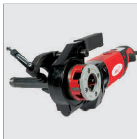
Установка клуппа на трубе с помощью струбцины
