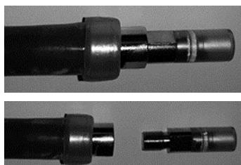
Для замены контактов штекера осторожно сдвинуть передний кожух (защиту от касания) в направлении кабеля, освободив обе поверхности под ключ.
