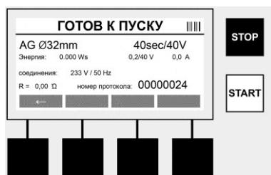
Диаметр ..... Диаметр трубы в соответствии с кодом муфты
