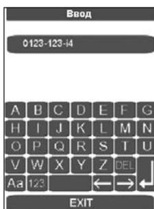
Нажатием соответствующего поля индикации вызывается шаблон ввода. Данные можно удалить при помощи DEL и ввести заново; эти данные затем переносятся в протокол.
