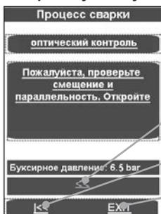
При помощи клавиш со стрелками программа возвращается к «Измерение давления вынужденного потока»
