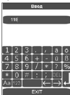
Нажатием соответствующего поля индикации можно ввести отличающиеся от нормы значения и сохранить при помощи ENTER. В пункте «Норма» изменяется обозначение, которое позже перед распечаткой протокола с ПК ввести в поле «Примечание». После подтверждения и сохранения данных трубы при помощи ОК появляется главное меню.
