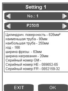
Нужные конфигурации машины можно выбрать при помощи клавиш со стрелками.
