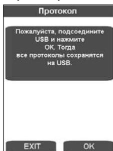
В пункте меню протокола можно записать данные при помощи ОК при подключенном USB-накопителе. Окно закрывается автоматически.
