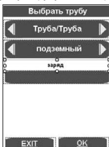
В заключительном обзоре параметров трубы данные отображаются согласно директиве DVS, ОК вызывает окно свариваемых частей и вида проводки.
