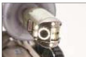
Видеокамера SR 50 с дополнительным освещением
