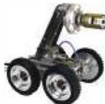
Робот FW 100 CT.2 с камерой SR50 на лафете с электрическим подъёмным механизмом для камеры и дополнительным освещением
