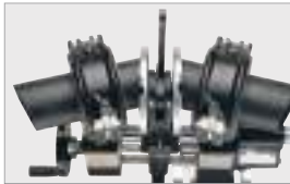
Двусторонняя градуировка (15° в обе стороны) широких основных зажимов даёт возможность изготавливать отводы
