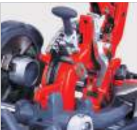
Автоматическая резьбонарезная головка со встроенной подачей масла
