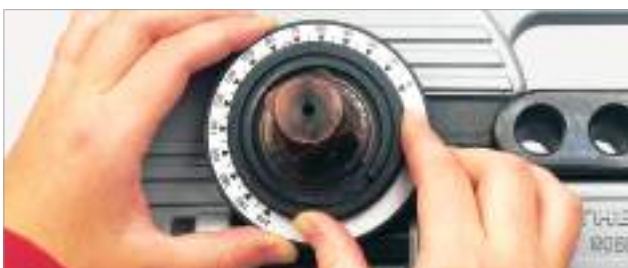
Предварительная настройка угла гибки без использования инструмента
