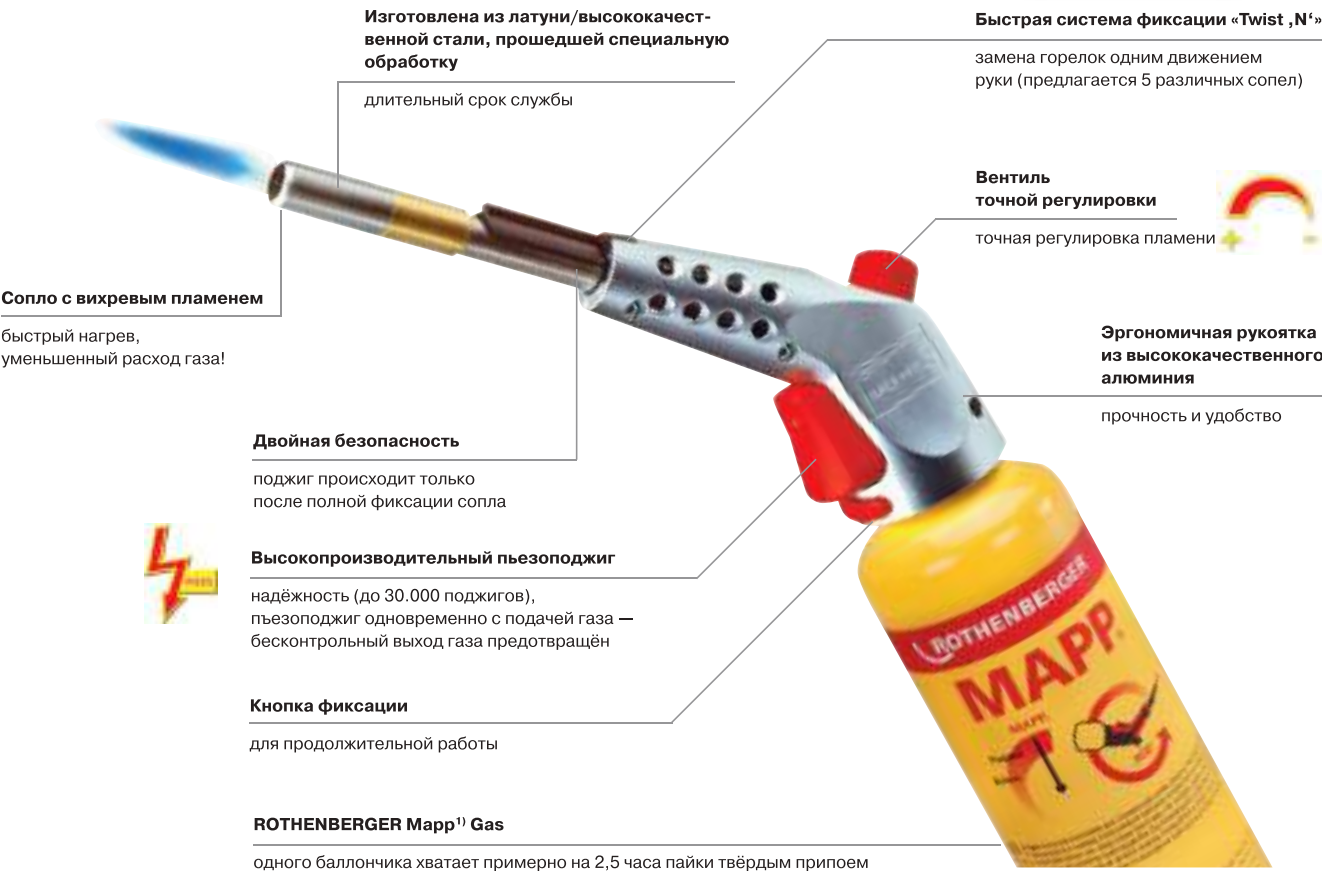
Высокая температура пламени благодаря циклонному завихрению
