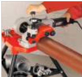
Применение устройства для накатки желобков ROGROOVER
