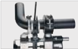
Соединение труба/фитинг с узким и широким зажимами
