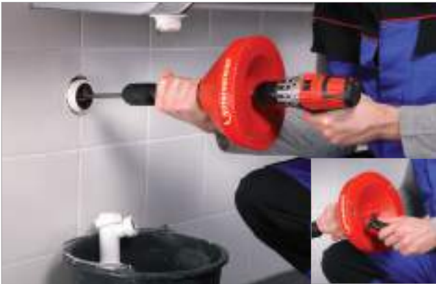
Использование шуруповёрта в качестве привода
