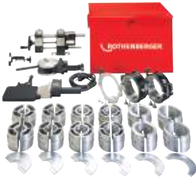
Двусторонняя градуировка (15° в обе стороны) широких основных зажимов даёт возможность изготавливать отводы
