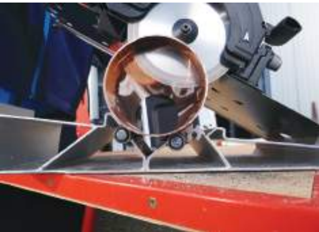
Функция зажима позволяет быстрее резать различные материалы
