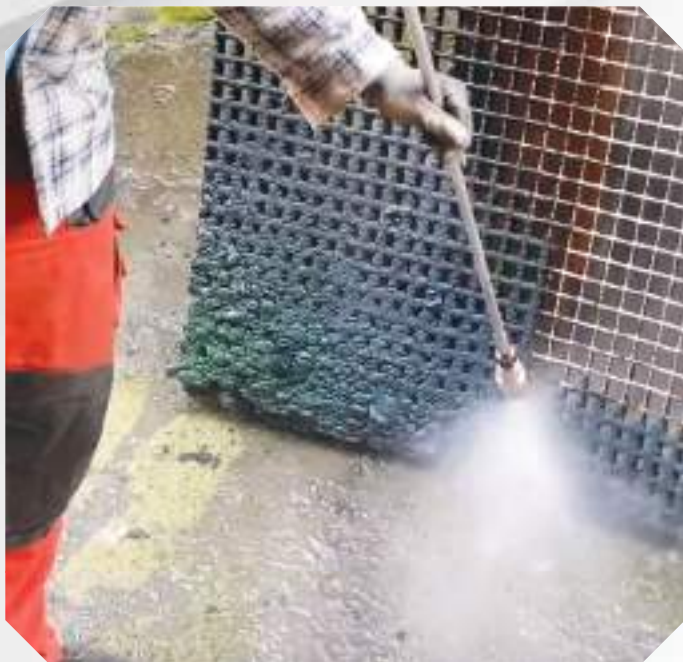
Чистка решётки окрасочной камеры
