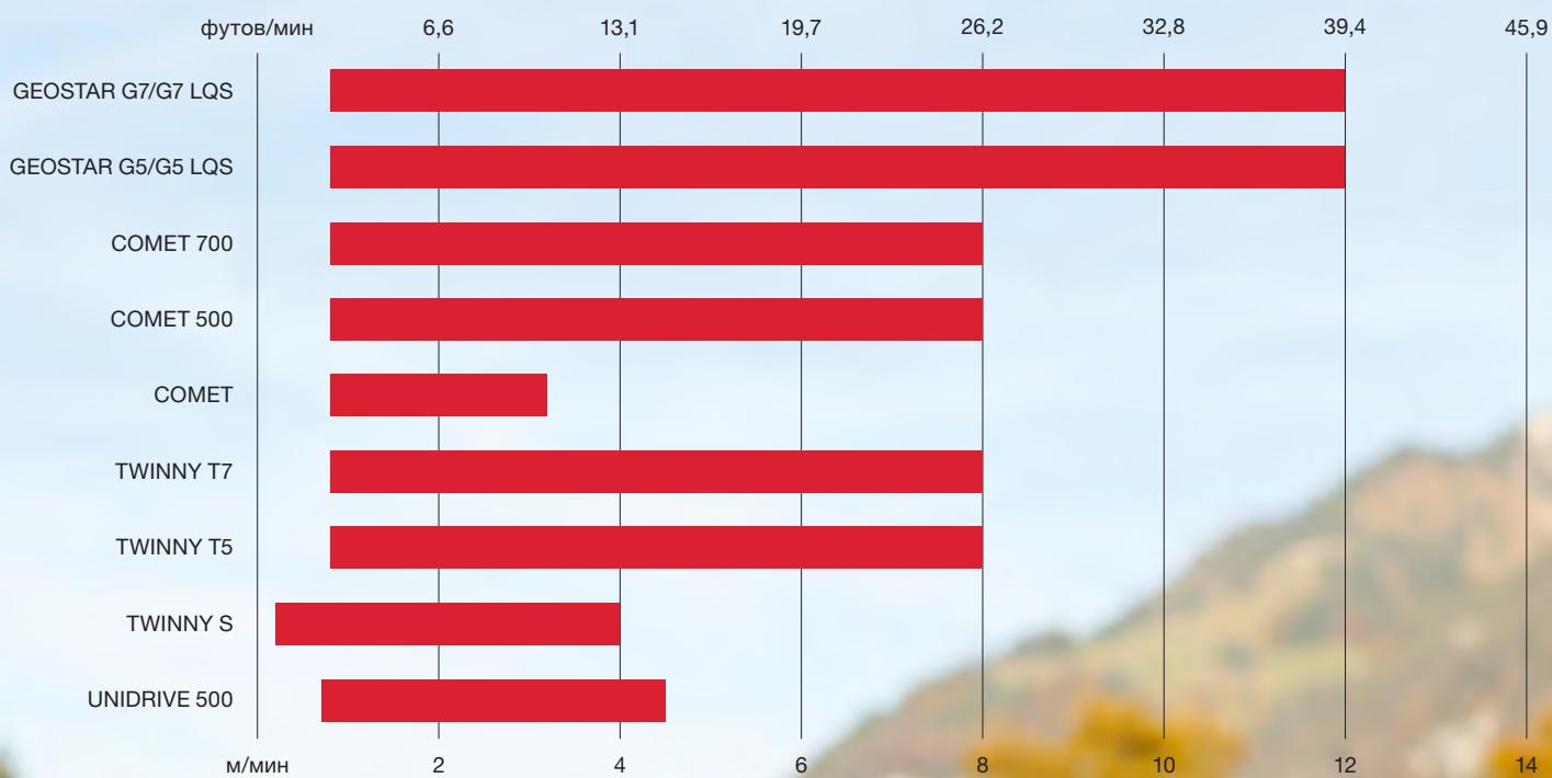
Скорость сварки в зависимости от свойств материала и воздействия окружающей среды
