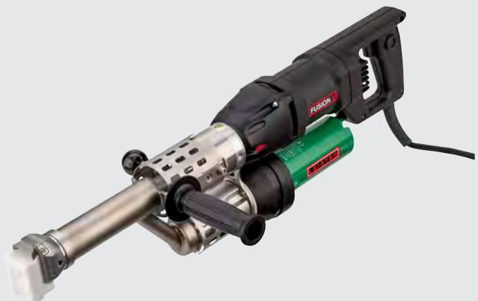
Экструдер FUSION 3 отличается узким корпусом и обеспечивает удобную эргономичную сварку ПЭ и ПП с большим выходным объемом. Отлично подходит для подземного строительства.
