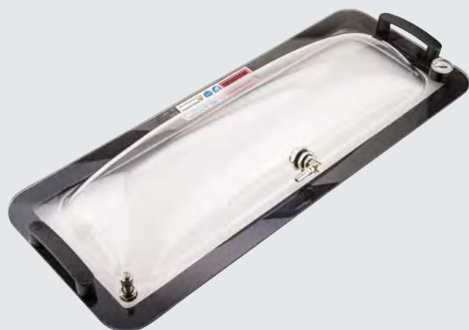
VACUUM BOX позволяет легко проверить сварные швы пластиковых деталей на наличие утечек. Он состоит из прозрачного ударопрочного пластика, надежно герметизирован и идеально подходит для работы в области геопроектов.
