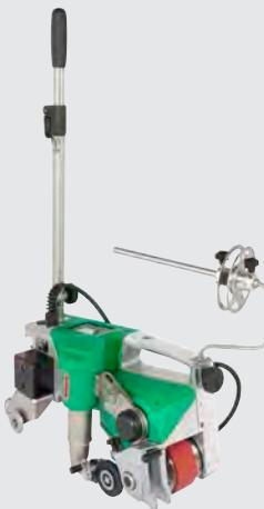
Автоматический напольный сварочный аппарат UNIFLOOR 500 предназначен для сварки эластичных напольных покрытий из пластика и антистатических ESD-покрытий, а также натуральных покрытий из линолеума и резины.
