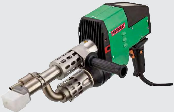
Мощный экструдер WELDPLAST S4 поставляется в двух вариантах: для сборки оборудования и контейнеров с горизонтальной насадкой для горячего воздуха, а также для подземного строительства с насадкой для предварительного нагрева, которая устанавливается сверху.
