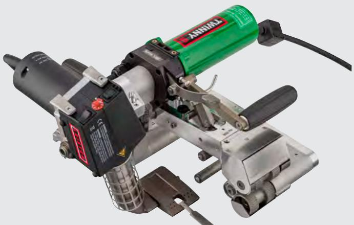
Сварочный аппарат TWINNY S с комбинированным клином предназначен для потолочной сварки при сооружении туннелей. В процессе используются тонкие геомембранны из ПВХ, ПЭВП и ПЭВД.
