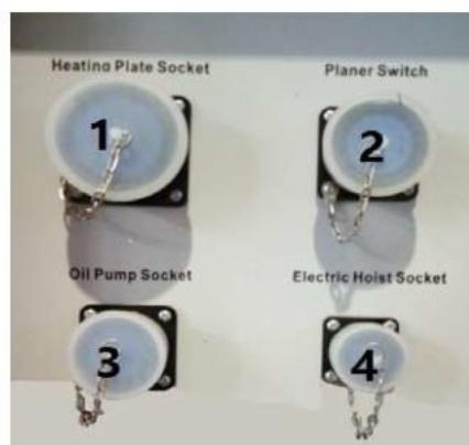
1. Гнездо нагревательного элемента 2. Переключатель торцеватель
