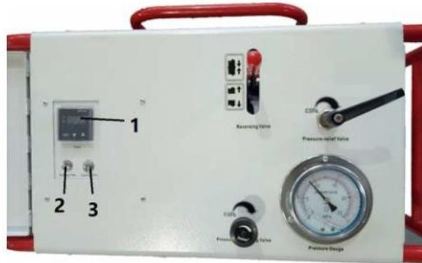
1. Таймер 2. Кнопка индикации эндотермического времени 3. Кнопка индикации времени охлаждения
