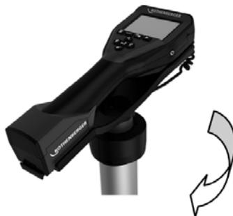
Поверните портативный прибор так, чтобы его можно было снять с корпуса и вернуть обратно в исходное положение.
